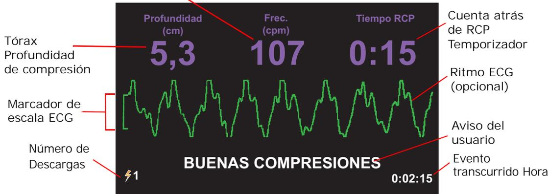
**NOTA** Cuando se usan los CPR Uni-padz en la posición de colocación Pediátrica, el ritmo del ECG aparecerá invertido en la pantalla. Si bien esto puede resultar incómodo a la hora de visualizar el ECG, no reduce en absoluto el rendimiento del algoritmo del desfibrilador, ni la eficacia de la energía aplicada.
